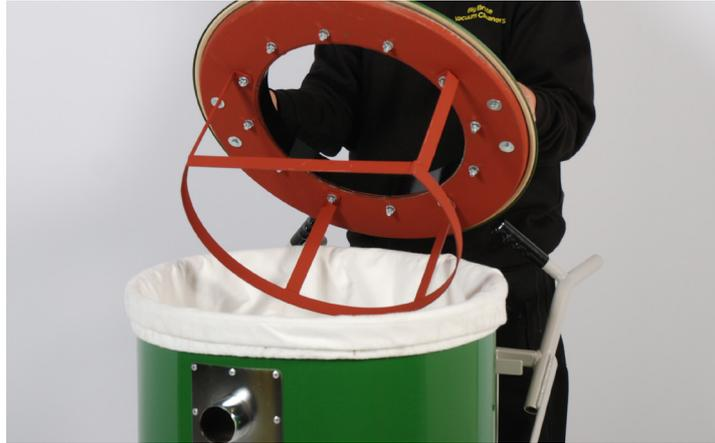
**juster le Couvercle avec la barre à plat sur le cadre intérieur adjacent à l'embout d'entrée du tambour**
