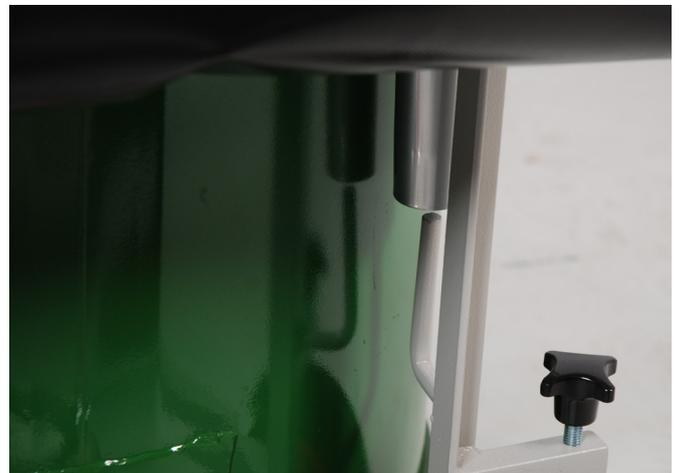
**Rangez le l'Outil Racleur V37 verticalement sur le bac d'égouttement à l'arrière du chariot et le Tube d'Extension en Aluminium V28 sur le crochet à l'arrière du chariot.**
