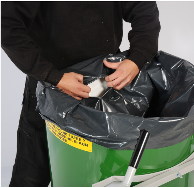
Sentez-vous pour le robinet d'entrée derrière le sac de déchets et déchirer un petit trou dans le sac
