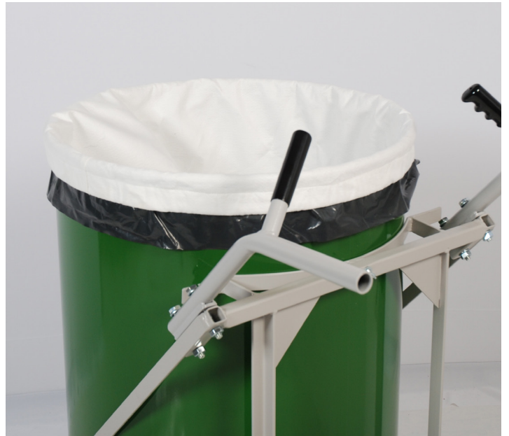
Plier le bord du Filtre Primaire vers le bas sur l'extérieur du tambour.
