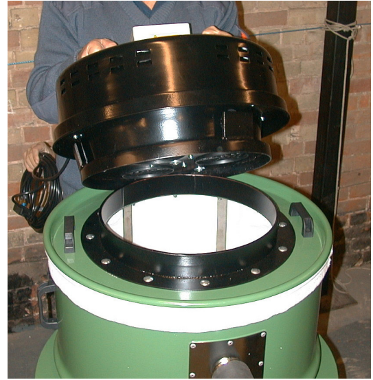
Placez l'Unité de Puissance sur le rebord supérieur
