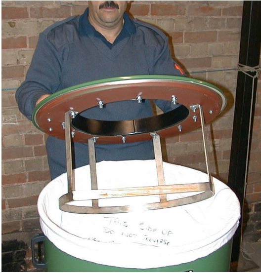
Placez le Couvercle sur les Filtres Primaires
