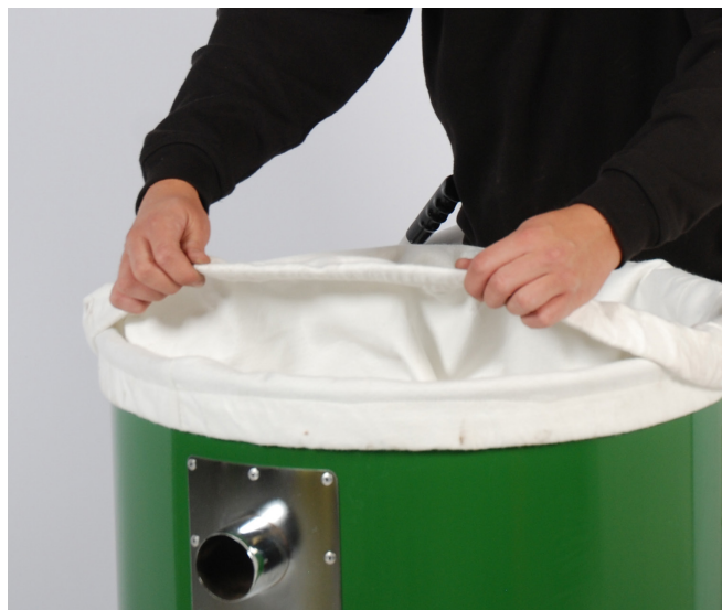
Monter les Filtres Primaires à l'intérieur du partie supérieure du Corps.
