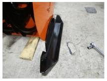
4) Fixer solidement les Skis de Glissement au collecteur de souffleuse à neige pour les fixer à l'aide du matériel fourni. Insérer les fixations telles que la tête plate du boulon se trouve dans le collecteur du logement et que la rondelle et l'écrou sont à l'extérieur du collecteur.
