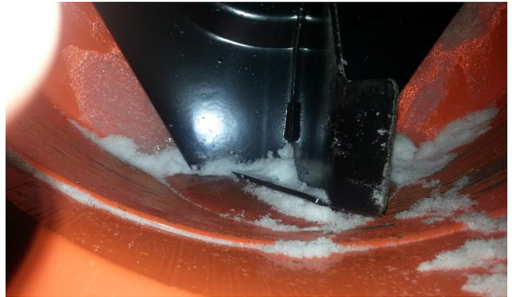
Si le rotor est bloqué quand la turbine / et la poignée du collecteur est engagée, la courroie ne tournera pas autour de la poulie du moteur ce qui peut casser la goupille de retenue.
