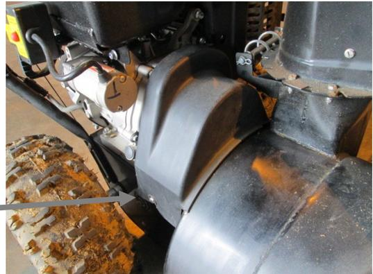
1. Desserrer les deux vis de chacun des côtés du couvert. Le couver vas se lever et éloigner du chasse-neige durant le remplacement. Les boulons requièrent une clé ou douille de de clé à rochet de 10mm.
