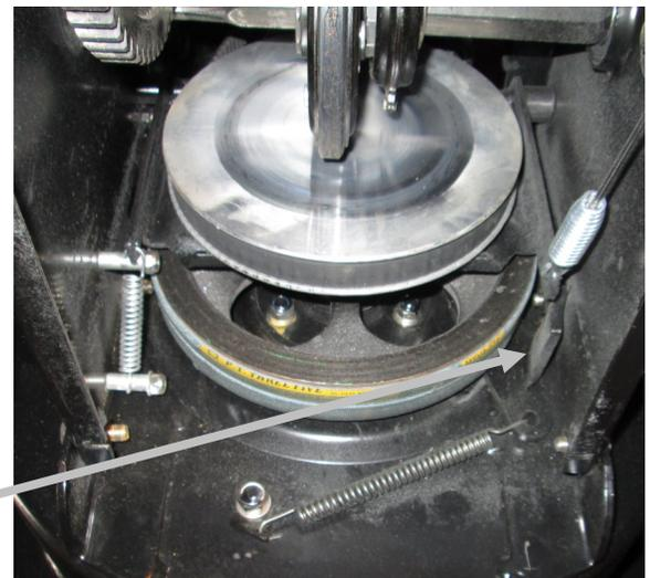
**IMPORTANT!** Ces courroies de chasse-neige sont ajustées pour s'assurer que la tarière arrête de tourner en deçà de 5 secondes suivant le débrayage du levier de commande de la turbine. Si vous faites des ajustement des courroies de quelque façon que ce soit, pour votre sécurité et celle des autres autour de vous, vous devez vous assurer que la courroie est réajustée conformément aux spécifications
