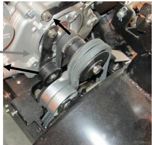
2. Éloigner la poulie de tension de la courroie en tirant sur le bras. Pendant que vous tirez le bras de tension, pousser la courroie vers le moteur- dégagée de la poulie et de l'arbre à came.
